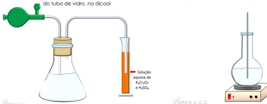
Figura 10: Captura de tela - Oxidação de álcool - teste do bafômetro (a esquerda) e Oxidação de aldeído - formação do espelho de prata (a direita). Fonte: Próprios autores (2017).
